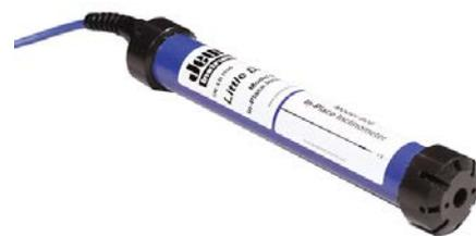
Gli inclinometri in-place sono utilizzati per monitorare le prestazioni di pendenza e argini. I singoli sensori biassiali sono collegati da aste in vetroresina che scorrono in un involucro inclinometrico standard con un diametro di 2,75 pollici o superiore.
